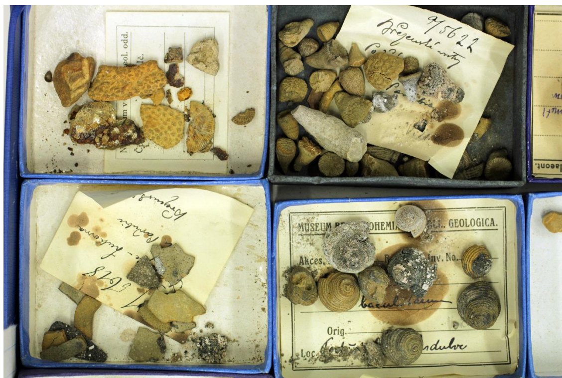
Obr. 6-4 Projevy silné degradace. Papír v blízkosti degradujících exemplářů je zcela rozložený, degradující exempláře jsou pokryty mikroskopickými krystaly sulfátů
