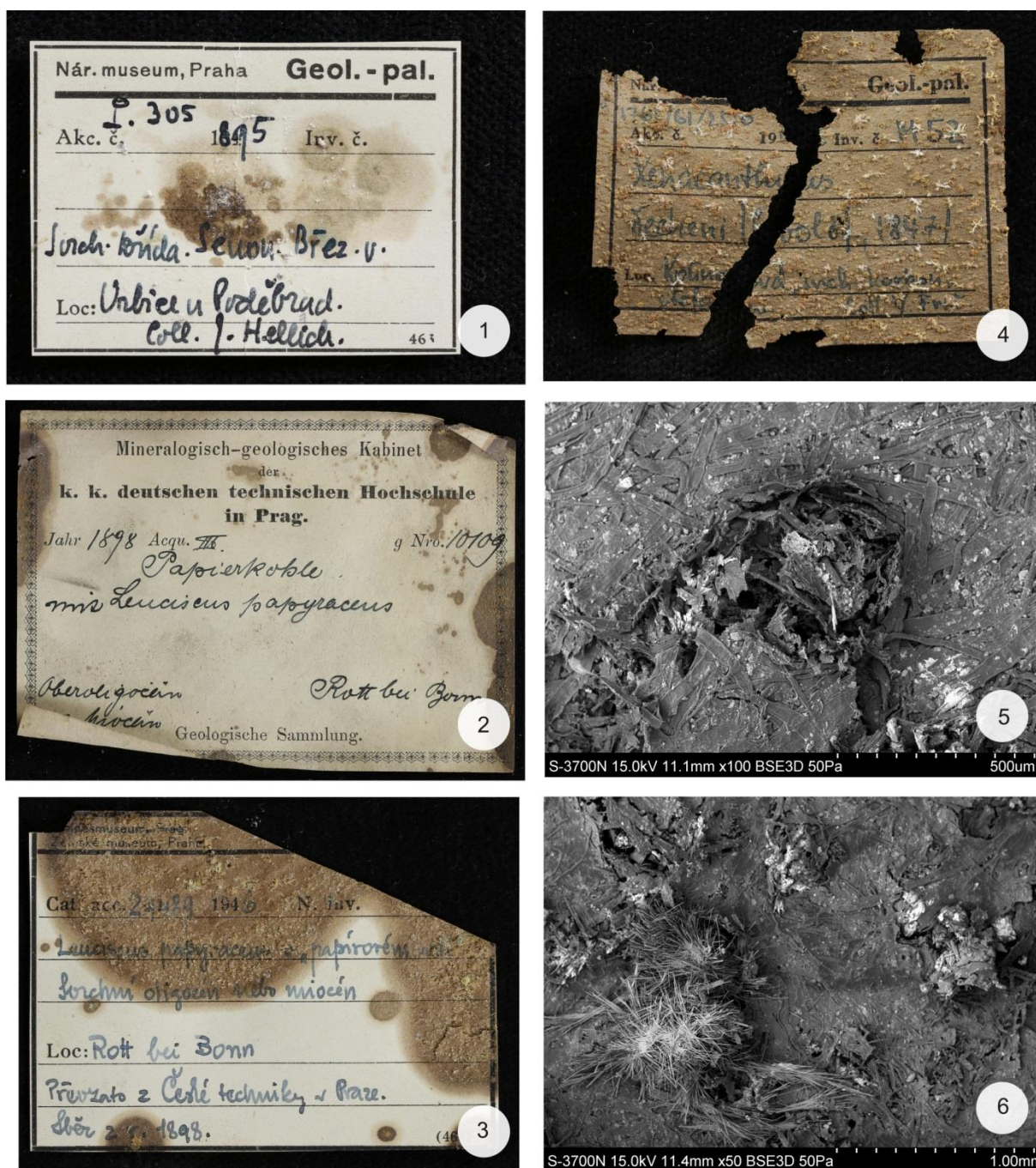
Obr. 15-1 Příklady etiket postižených produkty degradace sbírkových předmětů.
