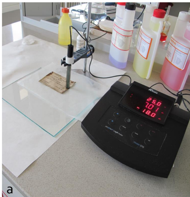
Obr. 15-3a, b Měření pH papírové podložky identifikačního štítku dotykovou elektrodou
