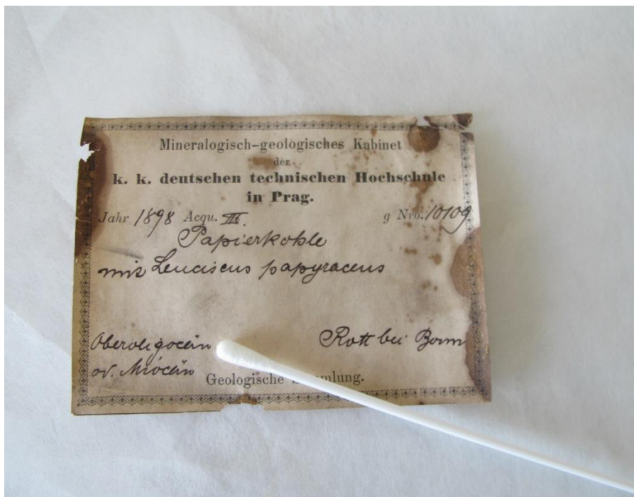
Obr. 15-2 Testování rozpustnosti záznamových prostředků ve vodě
