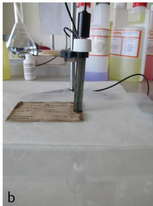
Obr. 15-3a, b Měření pH papírové podložky identifikačního štítku dotykovou elektrodou
